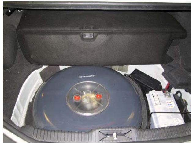
Installazione del serbatoio gpl
